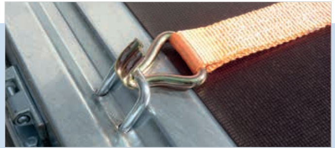
Zurrösen im Brückenlängsträger versenkbar bei PHL
